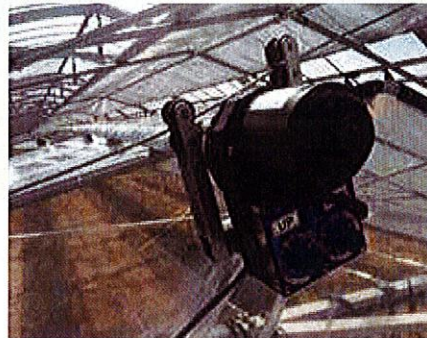
内張り巻き上げカーテン
